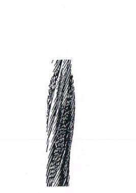
**Cliché 13** - Aumento local del diámetro de un cable con capa de aceite, causado por la extrusión del aceite de entre los cordones. El cable debe ser retirado inmediatamente.
