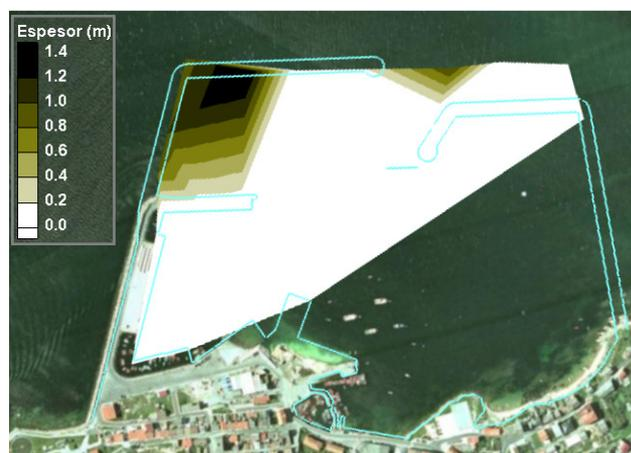
Nivel geotécnico II (Sustrato rocoso alterado)
