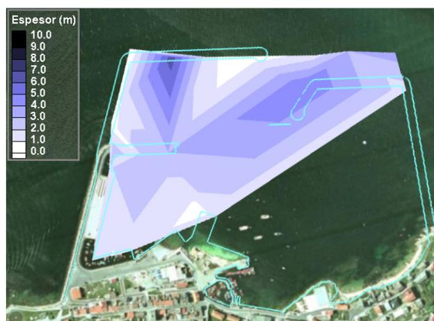
*Nivel geotécnico I inferior (Arenas cuaternarias)*
